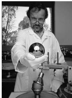
Abbildung 69: Silizium-Kugel für die Kilogramm-Definition (Avogadroprojekt, Physikalisch-Technischen Bundesanstalt in Braunschweig). Die Frage, ob sich damit die Basis für ein künftiges intergalaktisches Handelsabkommen legen lässt, konnte auf der letzten Conférence Générale des Poids et Mesures (Paris, 2014) noch nicht entschieden werden.
