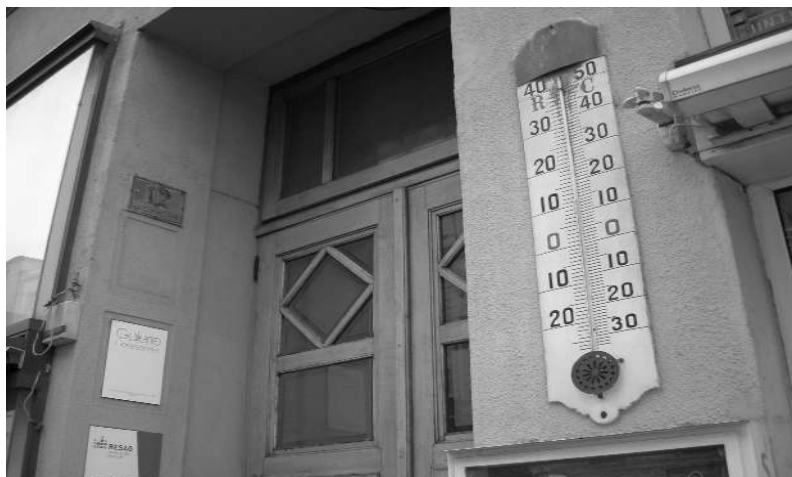
Abbildung 49: Réaumur-Skala (links) und Celsius-Skala (rechts) an einem Ausdehnungsthermometer in Wien. Die beiden Temperaturskalen haben unterschiedliche Einteilung aber den gleichen durch einen Temperaturfixpunkt definierten Nullpunkt.
