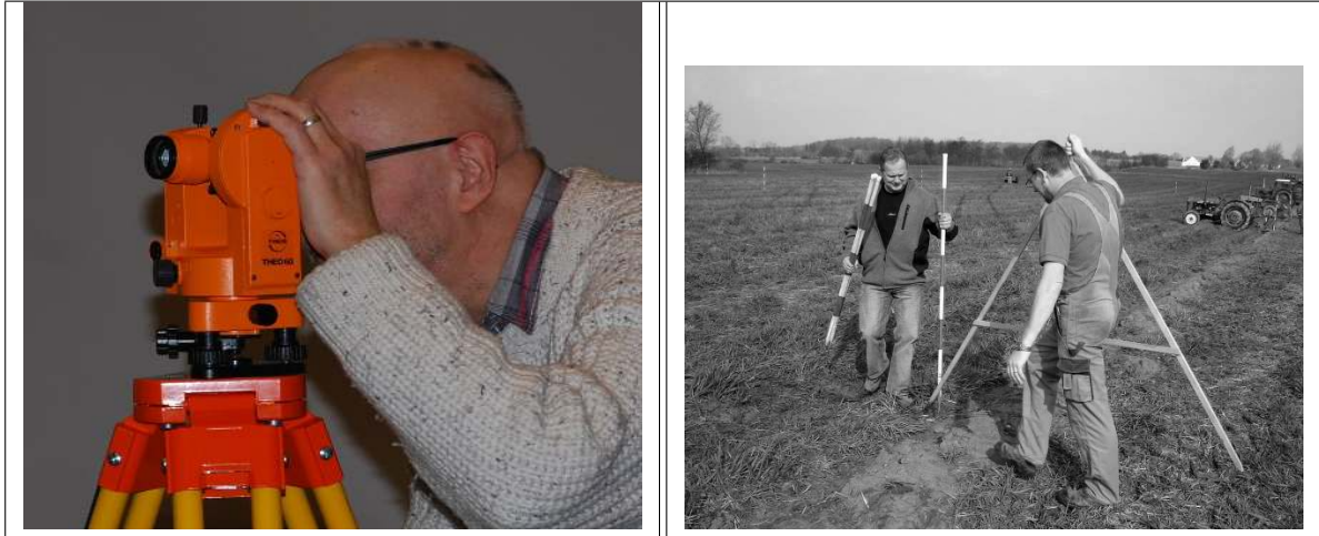
Abbildung 1: (a) Vermessung mit einem Theodoliten. Grundlage ist die Annahme, dass sich Licht geradlinig ausbreitet. (b) Entfernungsmessung mit dem Feldzirkel.
