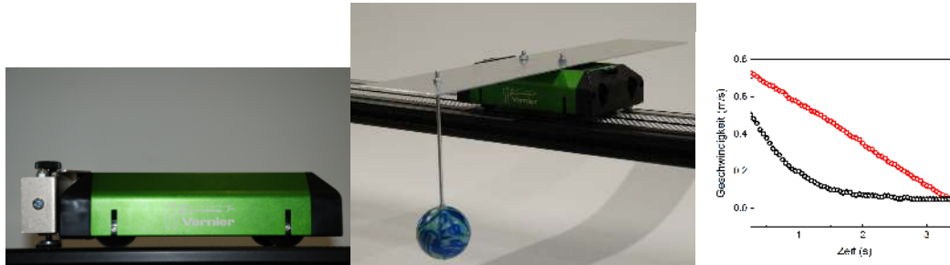
Abbildung 38: Dissipationsgesetze. (a) Wagen mit einer Filzplatte, die in einstellbarer Weise auf der Schiene schleift. (b) Wagen mit Ausleger. Der Ball bewegt sich in einer mit Glyzerin gefüllten Wanne. (c) Im ersten Fall nimmt die Geschwindigkeit linear mit der Zeit ab, im zweiten Fall nichtlinear.
