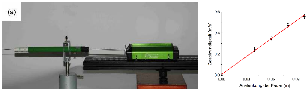
Abbildung 36: Hookesches Gesetz: (a) Eine Feder wird um eine Strecke x ausgelenkt und losgelassen. Auf einen Wagen, der sich auf einer horizontalen Bahn befindet, wird Energie übertragen. Die dem Wagen erteilte Endgeschwindigkeit wird gemessen. (b) Trägt man Geschwindigkeit gegen Federauslenkung auf, erkennt man im Rahmen der (durch Fehlerbalken angegebenen) Messunsicherheit einen linearen Zusammenhang. Daraus folgt das Hookesche Gesetz (Gl. 12.29).
